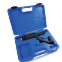
SSR953E 1/2" F x 3/4" M 1500NM MINI TORQUE MULTIPLIER MAX. INPUT TORQUE: 158Nm MAX. OUTPUT TORQUE: 1500Nm PROTECT
