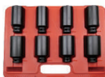
SSR969E 8PC 1/2"DR. SHAFT IMPACT DEEP SOCKET (12PT) SIZES: 29/ 30/ 32/ 34/ 35/ 36/ 38/ 39 mm
